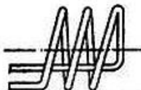
Rys. 6. Wykonanie cewek dla wyższych zakresów
